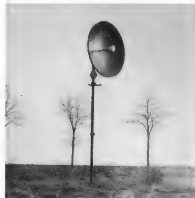
Bild 3. Scharf bündelnde Parabol-Meßantenne zum Ausmessen des Vertikaldiagramms
