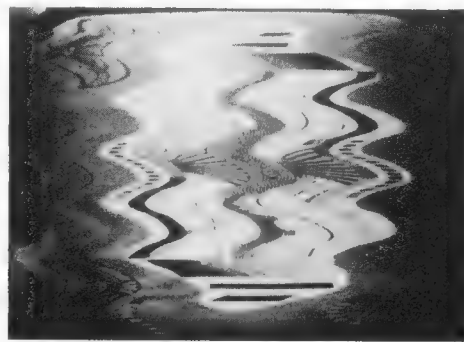
Regelschwingungen a) Entstehung b) Auswirkung auf das Fernsehbild
