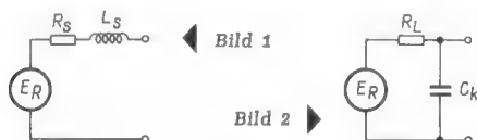
Bild 1. Ersatzschaltung des dynamischen Mikrofons. R_S = Widerstand der Schwingspule, L_S = Induktivität der Schwingspule, E_R = Rauschspannung
